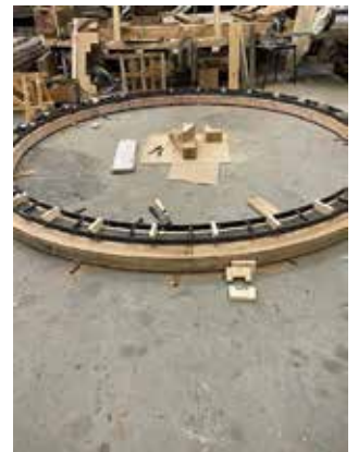
Het stalen kruierwerk op de ovenring
